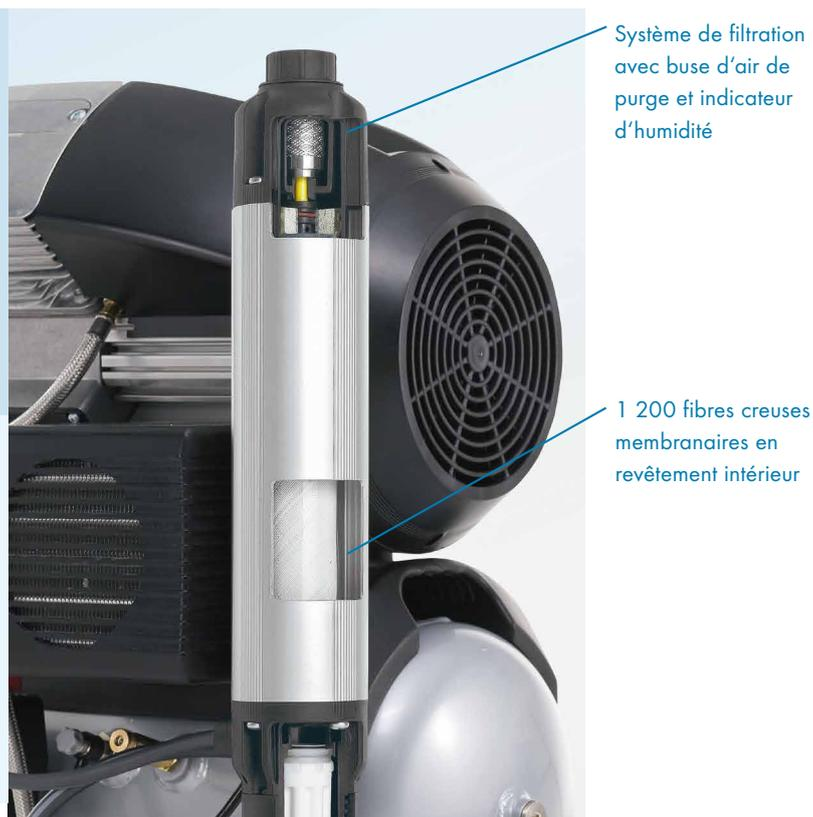
Après que le compresseur ait fonctionné pendant une durée prolongée, l'humidité augmente dans le dessiccateur par adsorption. Le dessiccateur à membranes par contre reste constamment sec et n'a aucunement besoin d'interruption de régénération.
